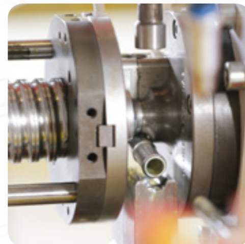
Automatisch öffnende Werkzeuge zum freien Entladen fertig gebogener Teile
