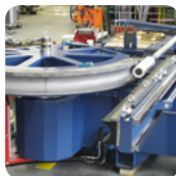
Radien bis 1.500 mm mit präzise bearbeitetem Segmentwerkzeug
