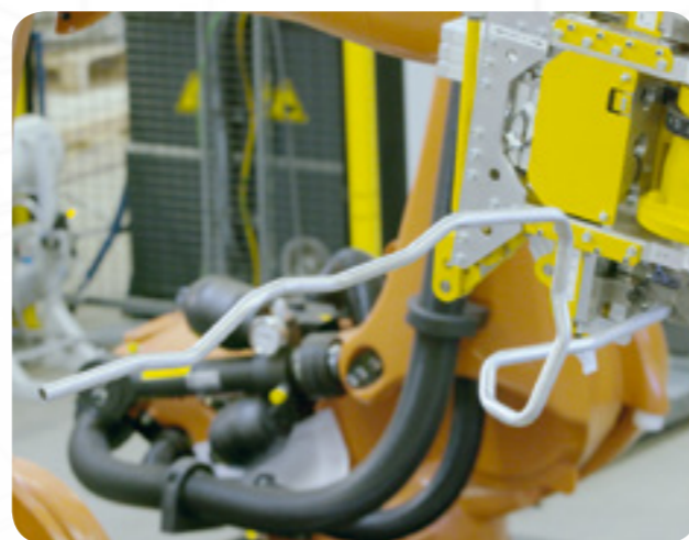
Roboter sind für ein effektives Handling einsetzbar oder übernehmen zusätzlich Biegeaufgaben.
