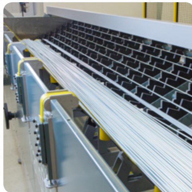
Stufengurtt Förderer – auch für kleine, lange Rohre optimal geeignet
