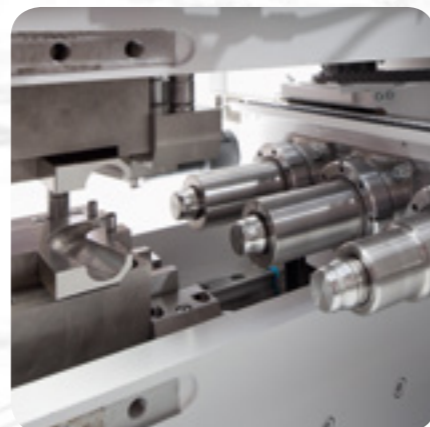
Schnell und flexibel im Einsatz: Umformwerkzeuge an einer axialen Rohrumformmaschine
